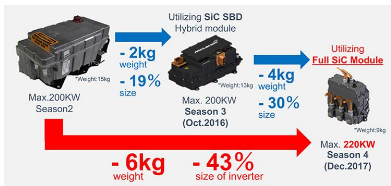
FIGURE I.12. EVOLUTION DU MODULE DE PUISSANCE EQUIPANT L'ONDULEUR DE L'EQUIPE VENTURI PARTICIPANT AU CHAMPIONNAT DE FORMULE ELECTRIQUE, ENTRE LA SAISON 2 ET LA SAISON 4 (36)
